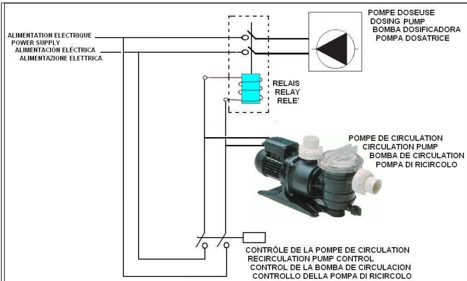
**FR** ! IMPERATIF ! La pompe ne doit injecter que lorsque de l'eau circule dans la canalisation.
