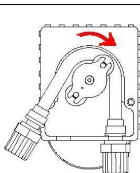
**FR** Enlever le couvercle transparent en dévissant les deux vis sur le frontail. Enlever le vieux tuyau en débloquent d'abord le raccordement de gauche, en tournant dans le sens de la flèche le porte galet de façon à libérer le tuyau jusqu'au raccordement de droite.
