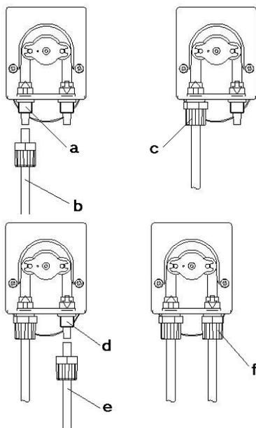
**FR** Aspiration: Lier le tuyau d'aspiration (b) au raccord d'aspiration (a). Fermer l'embout (c).
