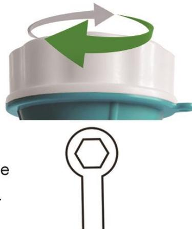
Remarque : Le bouchon doit être bien serré avec la clé. Une infiltration d'eau rend l'appareil inutilisable.
