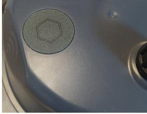
Appuyez sur le bouton de l'Ofix VP et attendez quelques secondes que votre Daisy VP s'y connecte. Une fois que celle-ci est connectée, les indicateurs LEDs affichent la mesure récupérée de l'Ofix VP et la pompe doseuse s'éclaire en fonction de celle-ci.
