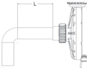
\* **NOTA** - Deverá haver um comprimento de cano direito (« L » na figura ao lado) superior ou igual a 5 vezes o diâmetro do cano entre a admissão da bomba de aspiração e os acessórios da canalização (cotovelos, válvulas, etc.).
