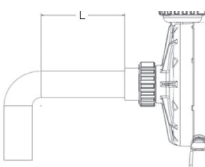
\* **ПРИМЕЧАНИЕ** - Предусмотрите прямой участок («L» на схеме) размером не менее 5 диаметров трубы между впуском всасывающего насоса и элементами трубопровода (изгибами, клапанами и т.п.).
