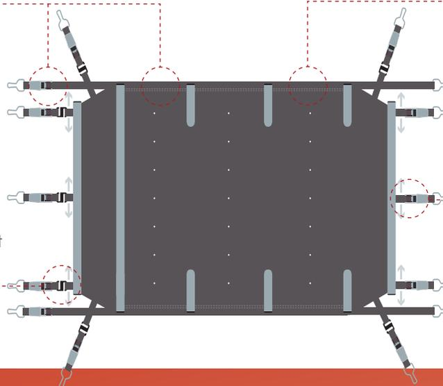
Les couvertures à barres Securit Pool **Hors sol Woody** sont conçues à partir de tissu enduit PVC 650 g/m<sup>2</sup> et composées d'un système de maintien au moyen de barres en aluminium anodisé. Elles sont dotées de cavités pour l'évacuation des eaux pluviales et sont livrées avec une manivelle manuelle démultipliée ou un volant.
