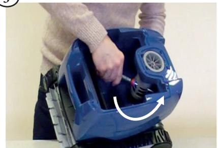
Desserrer le guide flux à l'aide d'un tournevis
