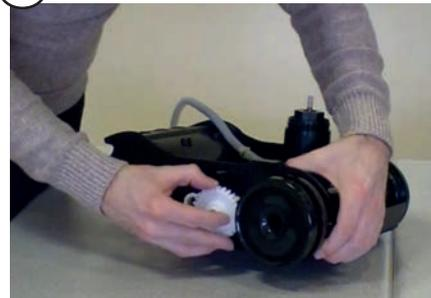
Positionner la goupille avant de mettre la roue
