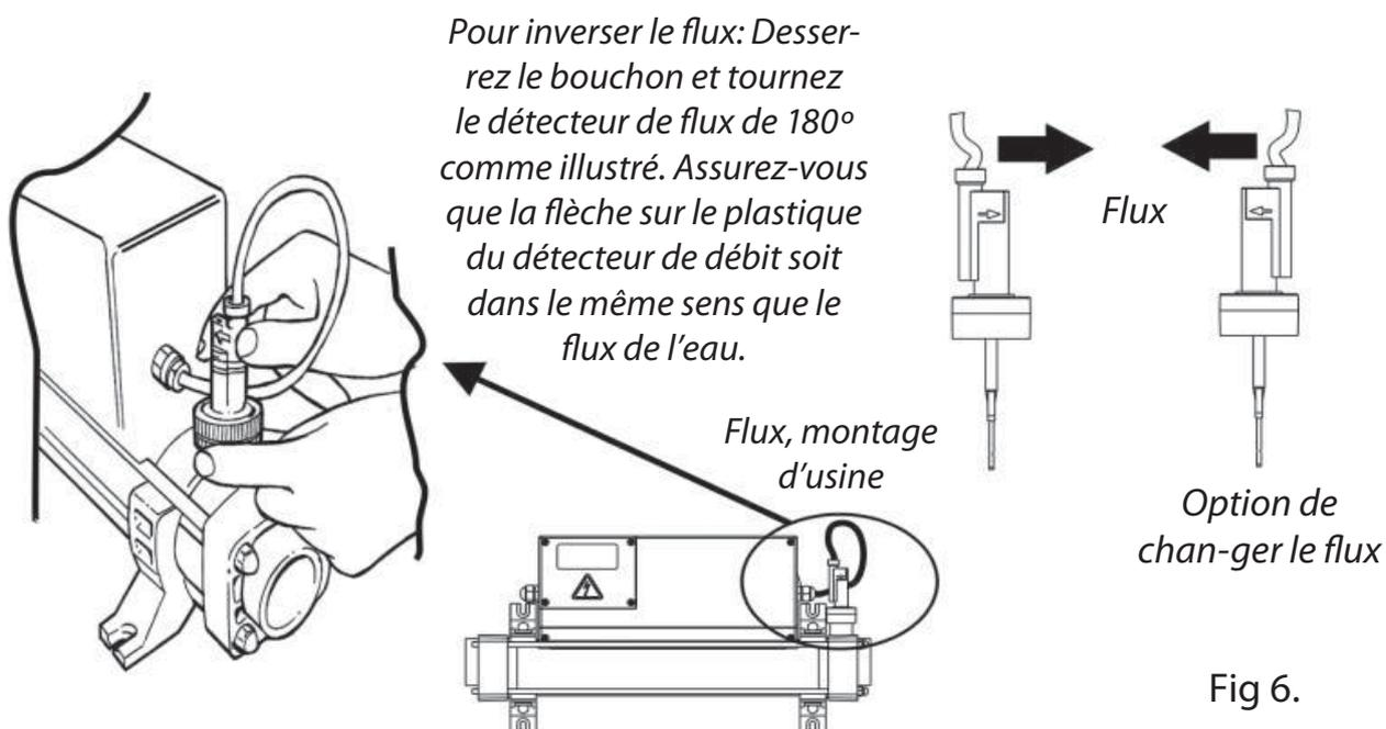
Le flux d'eau dans le réchauffeur ne doit pas dépasser les 17.000 litres par heure. Un flux plus élevé nécessitera l'installation d'un système de bypass pour éviter l'endommagement des résistances. Le réchauffeur ne se met pas en marche jusqu'à ce que le flux minimum obligatoire soit atteint, soit:
