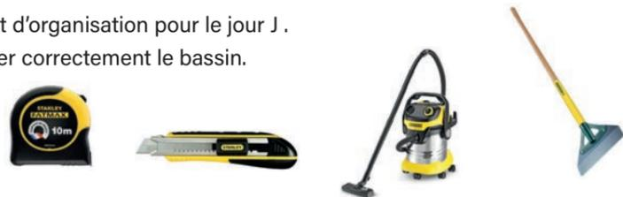
**1-** Le moindre petit caillou étant susceptible de percer le liner il faut passer sur le fond du bassin (radier) une raclette à béton voir si nécessaire une ponceuse.
