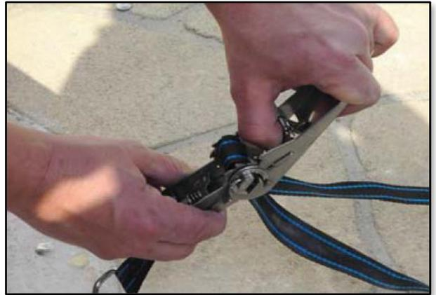
Veiller à ce que la sangle de déroulement soit dans l'axe de la couverture dépliée complètement sans nœuds, ni roulé en boule.
