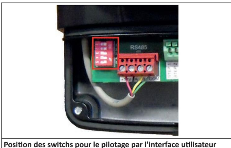
Position des switches pour le pilotage par l'interface utilisateur
