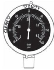
**Position flèche «DIRTY» = indique que la pression dans le filtre a augmenté par rapport à la pression initiale de fonctionnement du filtre, et que la cartouche filtrante est sale**
