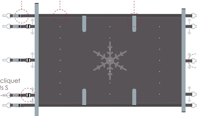
Les couvertures à barres Securit Pool **Summum Flex** sont conçues à partir de tissu enduit PVC 580 g/m<sup>2</sup> et composées d'un système de maintien au moyen de **barres composite / pultrusion**. Elles sont dotées de cavités pour l'évacuation des eaux pluviales et sont livrées avec une manivelle manuelle démultipliée haut rendement.
